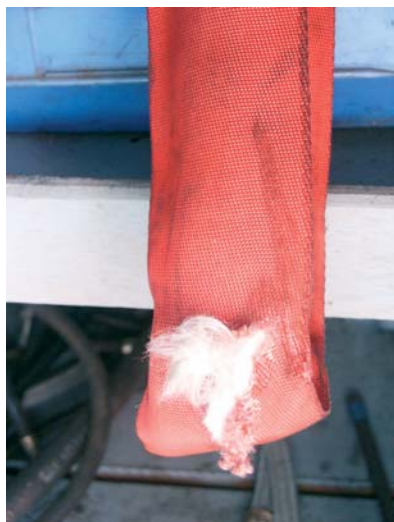
Abbildung 6: Ablegereife – Beschädigung der Ummantlung und Einlage bzw. durch Quetschung.
