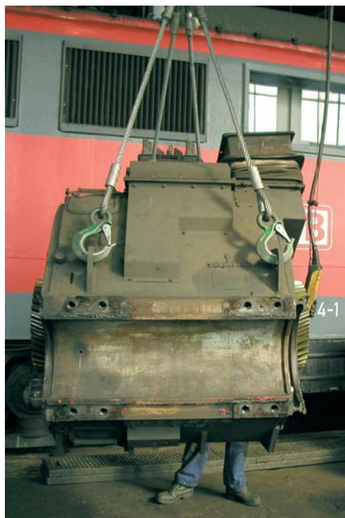
Abbildung 1: Für den Transport des elektrischen Fahrmotors wird ein viersträngiges Drahtseil mit Lasthaken als Anschlagmittel eingesetzt.
