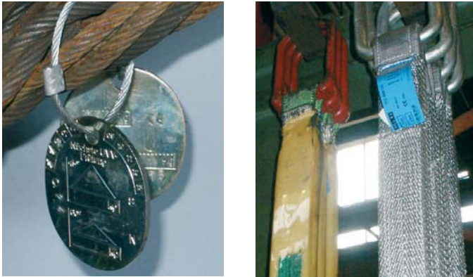
Abbildung 3: Drahtseilanhänger und Etikett eines Hebebandes mit Tragfähigkeitsangaben.
