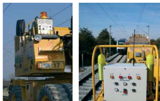
Abbildung 14: Warnsignalgeber auf Baumaschinen.
