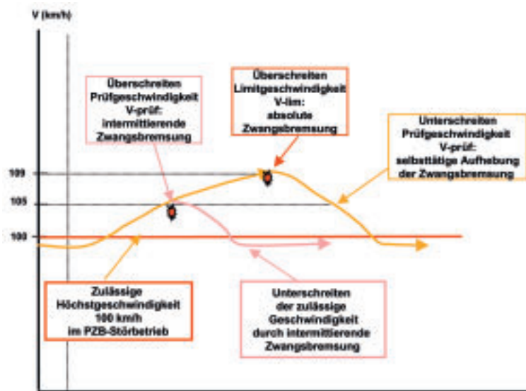
Abbildung 4: Zwangsbremse beim Überschreiten der Höchstgeschwindigkeit im PZB-Störbetrieb.
