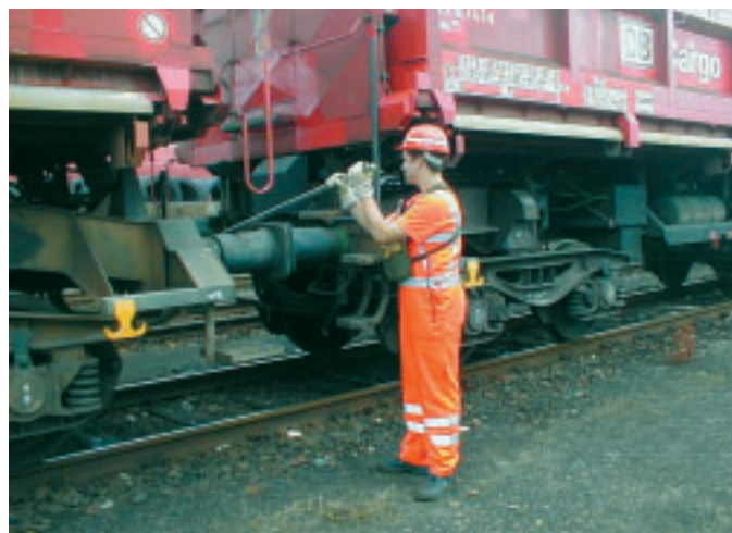
Abbildung 4: Lrf beim Entkuppeln mit Entkuppplungsstange.
