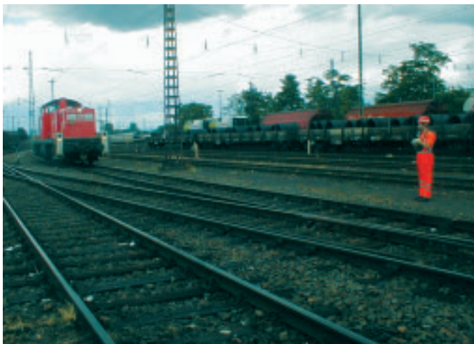
Abbildung 2: Lrf steuert von einem Standort neben dem Gleis.
