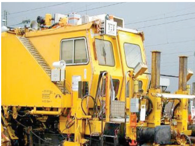
Abbildung 6: Warnsignalgeber auf gleisfahrender Baumaschine (Werkfoto Fa. Zöllner, Kiel).
