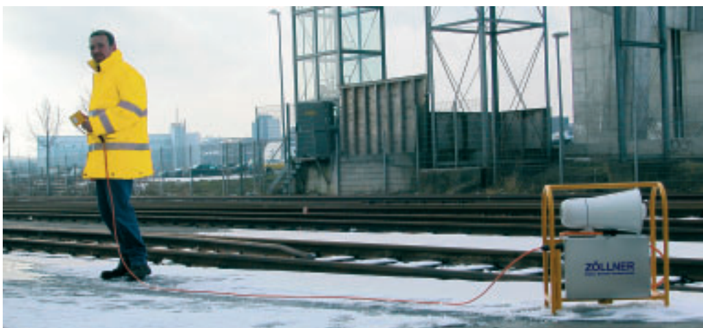
Abbildung 2: Von Hand fernbedienbarer Warnsignalgeber WGH 95/0 (Werkfoto Fa. Zöllner, Kiel).
