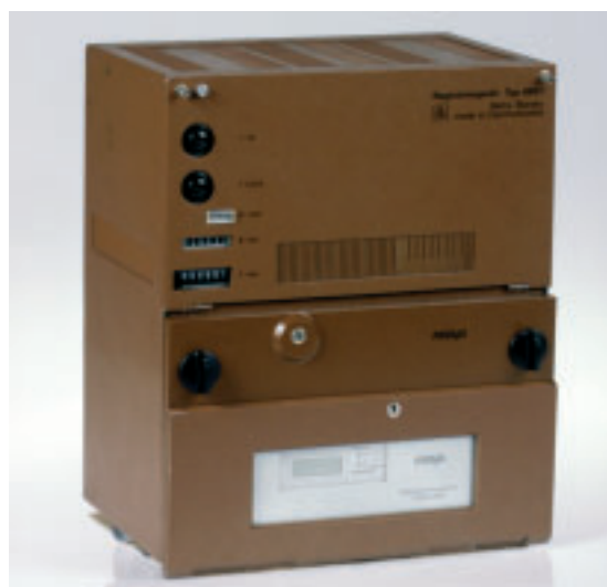
Abbildung 6: Das heute im Einsatz befindliche Registriergerät der PZ 80/PZ 80R mit elektromechanischem Schreibwerk.
