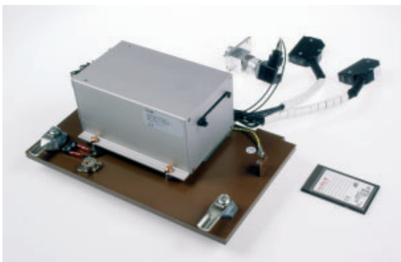
Abbildung 7: Das relativ einfach einzubauende neue Bauteil mit der elektronischen Registriereinrichtung DSE 8.
