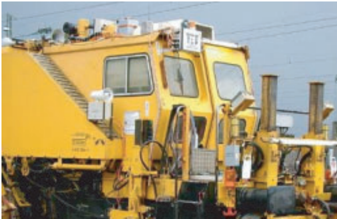
Abbildung 5: Warnsignalgeber auf Maschinen (Werkfotos der Fa. Zöllner und Schweizer).
