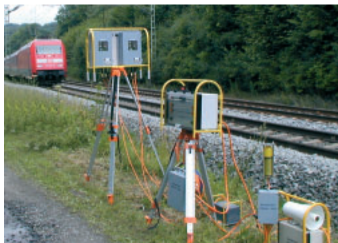
Abbildung 1: Die Autoprowa ist ein Beispiel für ein sicheres und die Bereitschaft der Funkverbindung überwachendes AWS.
