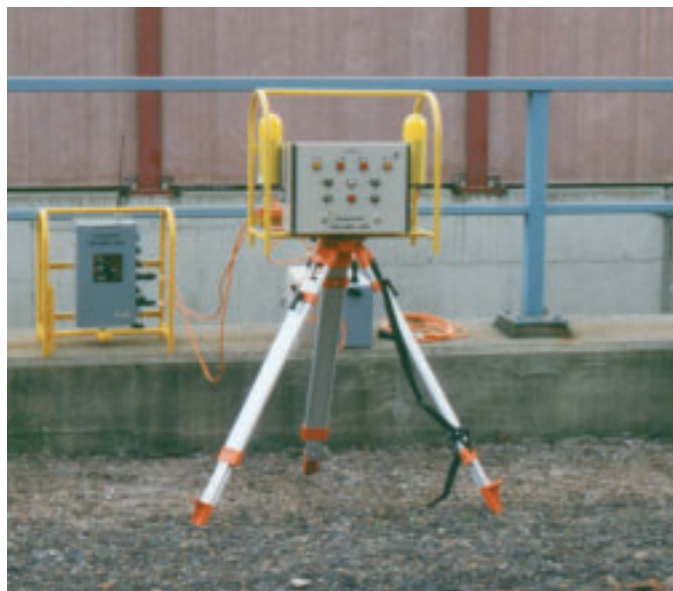
Abbildung 5: Die ZAL kann sehr schnell aufgebaut werden. Es besteht damit die Möglichkeit der sicheren, funkunterstützten Warnung für bewegliche, kleine Bautrupps.
