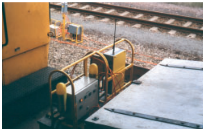
Abbildung 6: Die ZAL kann auch für die Warnung von Personen auf kleinen Schienenfahrzeugen, hier ein SKL, eingesetzt werden.
