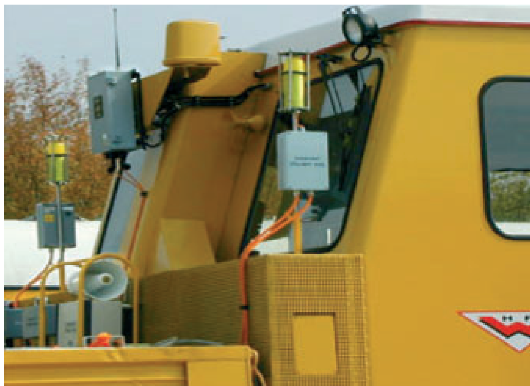
Abbildung 7: Aufbau einer Autoprowa-Anlage auf einer Gleisbaumaschine
