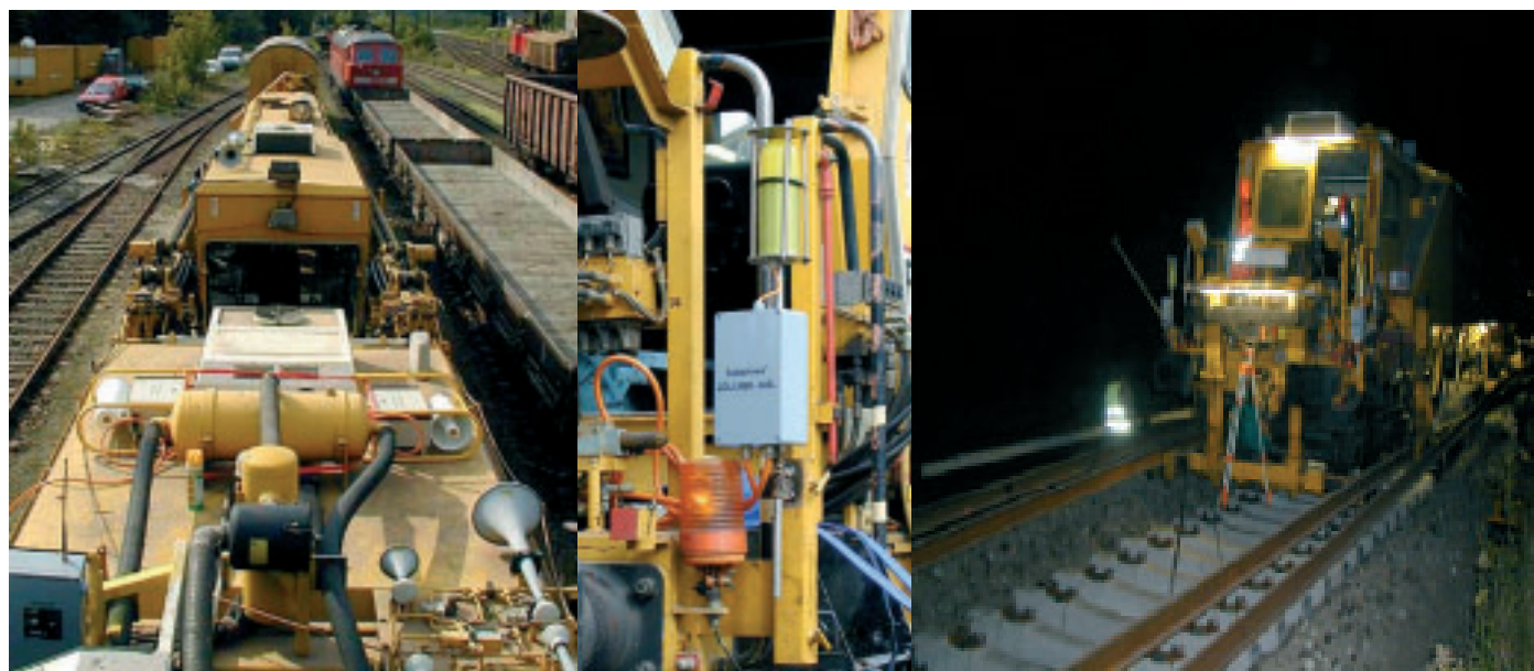
Abbildung 8: Aufbau einer Autoprowa-Anlage auf einem Gleisumbauzug
