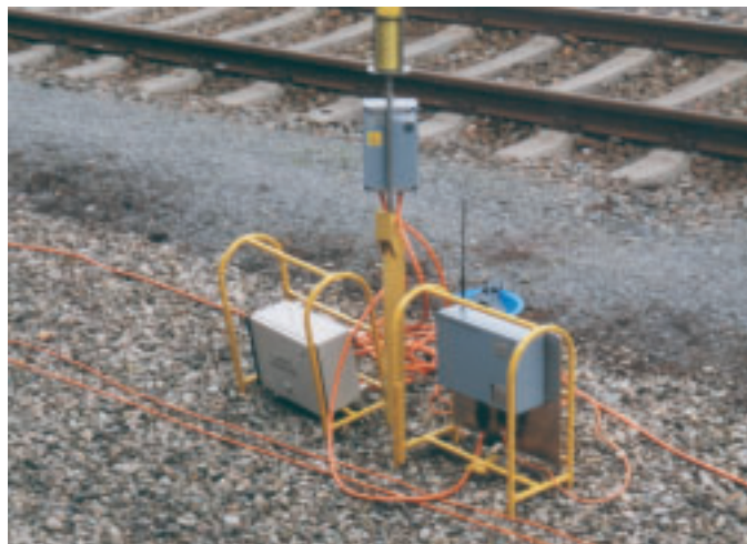
Abbildung 4: Die Funkmodule sind auch in die Warnebergerkette integrierbar, um eine optimale Flexibilität des Autoprowa Einsatzes zu gewährleisten.
