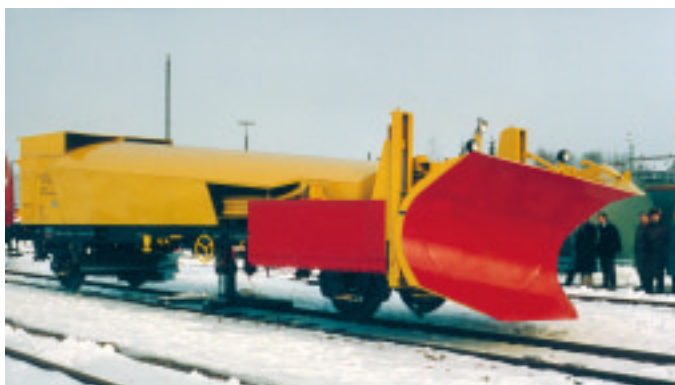
Abbildung 3: Funkferngesteuerter Schneepflug BR 850.
