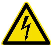
Warnzeichen Wo8 Warnung vor gefährlicher elektrischer Spannung
