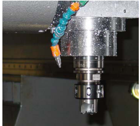
Bild 53 Äußere Schmierstoff-Zufuhr beim Fräsen
