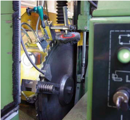
Bild 52 Säge zur Bearbeitung mit Minimalmengenschmierung
