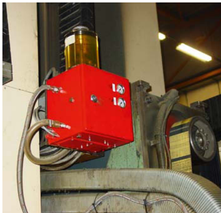
Bild 55 Sauberer Schmierstoff beim MMS-System
