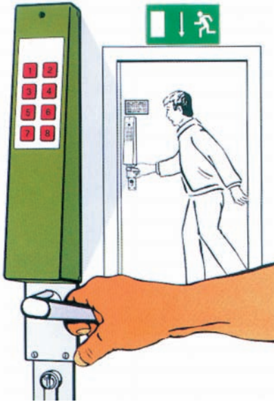
Bild 1: Einrichtung zur Anzeige der missbräuchlichen Benutzung einer Tür
