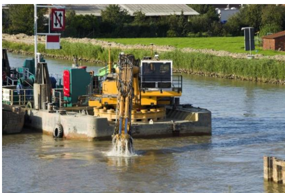
Abb. 2: Dauerhaft als konstruktive Einheit fest mit dem Schwimmkörper verbundenes Arbeitsmittel Hydraulikbagger (Fall B)
