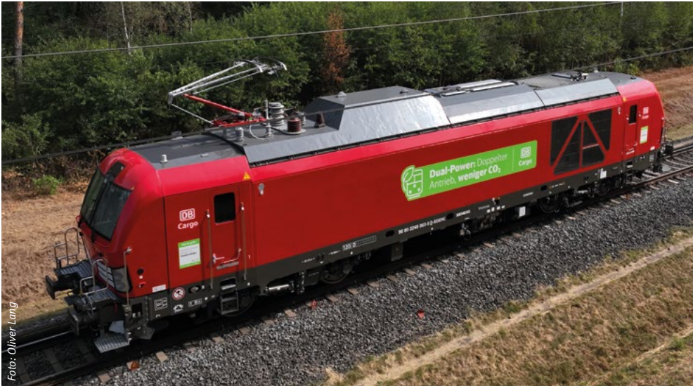
DB Cargo AG – Baureihe 249 – Zweikraftlokomotive vom Typ Vectron Dual Mode
