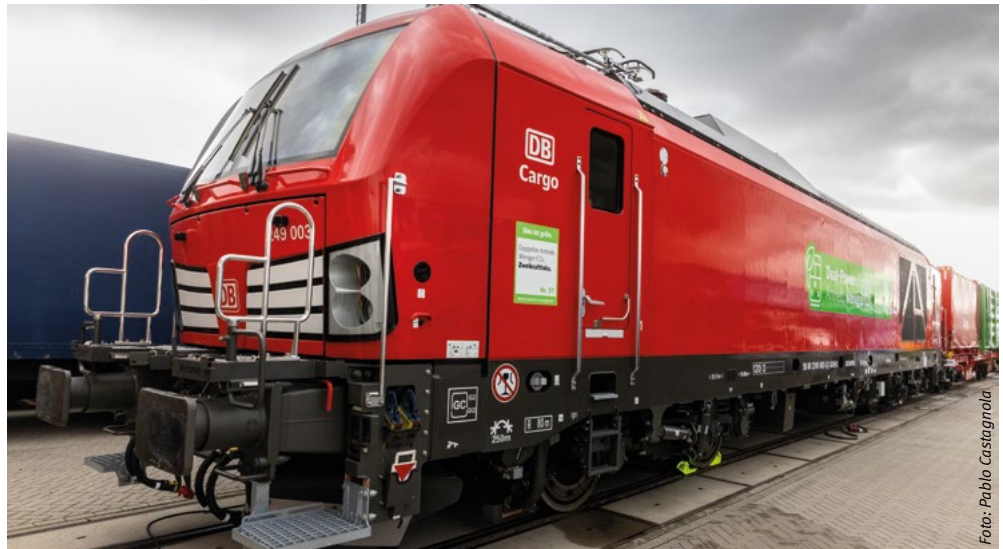
Die DB AG auf der InnoTrans 2022 – Baureihe 249 – Zweikraftlokomotive der DB Cargo AG
