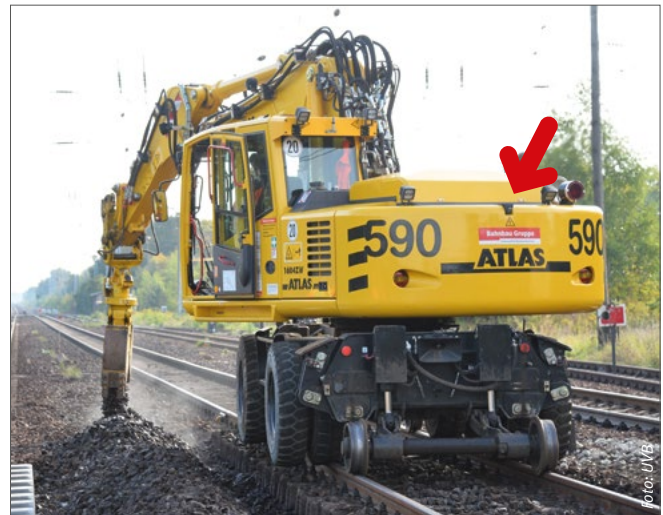
Abbildung 2: Die Rückraumüberwachung ist für Zweibegebagger seit vielen Jahren Standard
