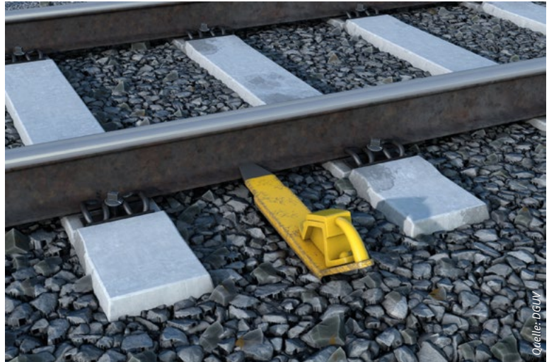
Abbildung 3: Neue Abbildung in Kapitel 6.6.1 der DGUV Information 214-089 – Ablagemöglichkeit für Hemmschuhe
