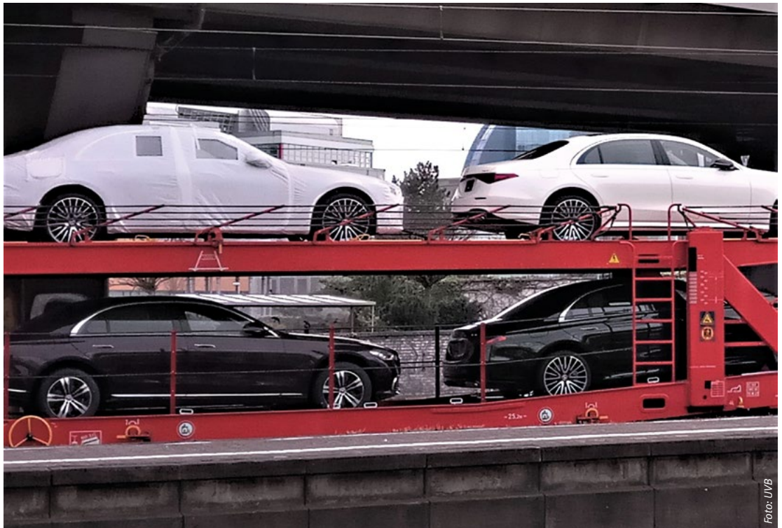
Abbildung 4: Autotransportwagen mit heruntergeklappter Absturzsicherung während der Fahrt
