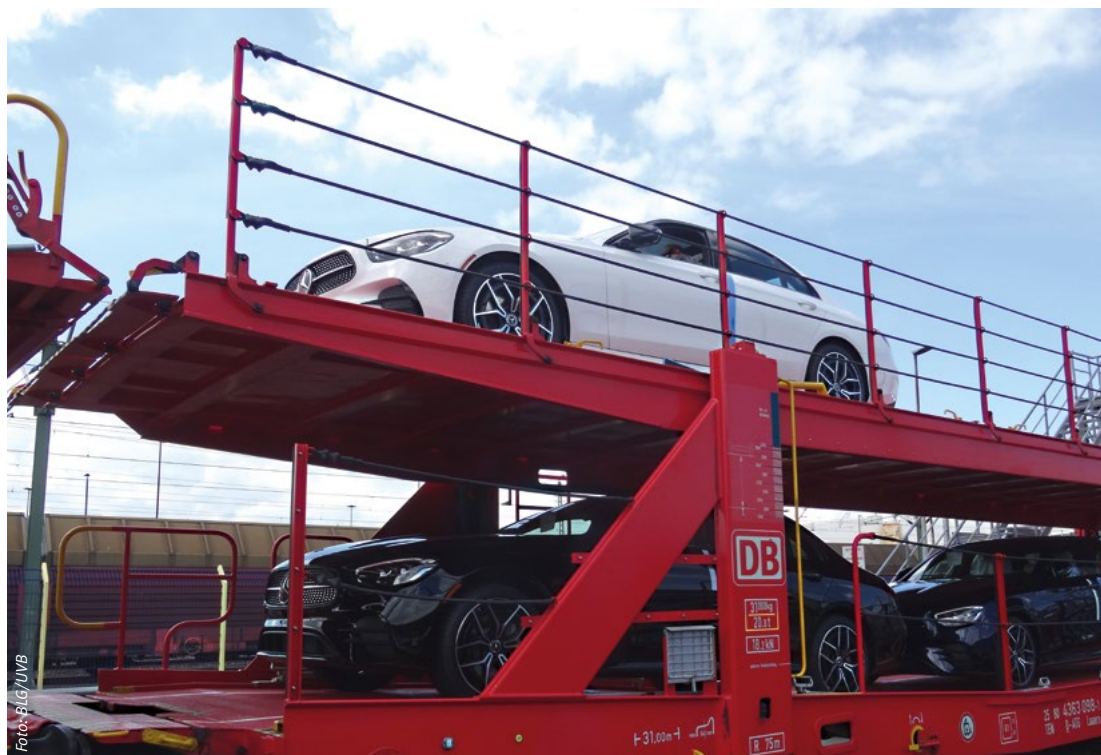
Abbildung 3: Autotransportwagen mit aufgestellter Absturzsicherung während der Be- und Entladung
