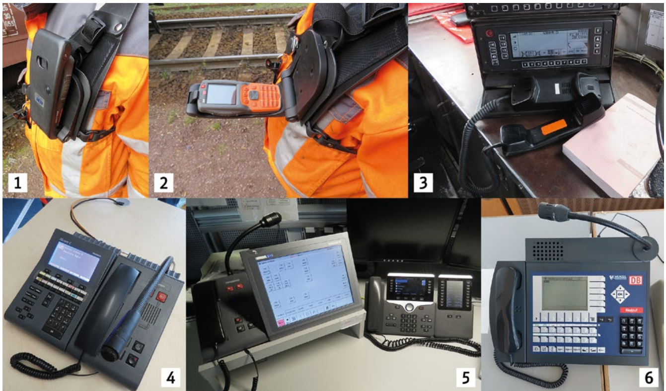
Abbildungen 1 bis 6: GSM-R-Endgeräte bei mobilen und ortsfesten Teilnehmern.
