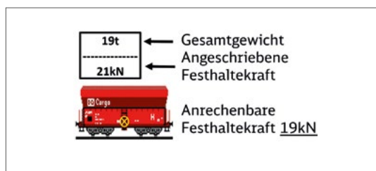
Abbildung 2: Berechnung Festhaltekraft der Feststellbremse
